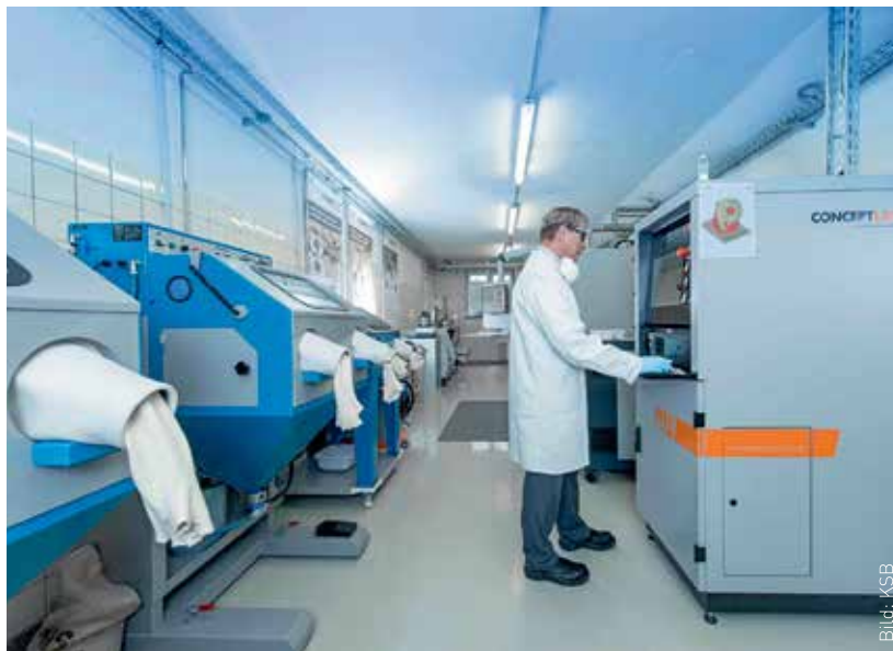
Eine der beiden Laserschmelzanlagen im Werkstofflabor des KSB-Werks in Pegnitz.
